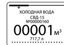
Для выбора счетчика или отмены произведите длинное нажатие на кнопку до начала мерцания подсветки. Над выбранным счетчиком появится или пропадет знак +.
