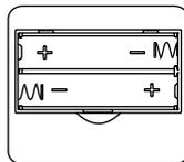
**2. Включение** Перед началом эксплуатации дисплея установите элементы питания в отсек для батареек (приобретаются отдельно). **Внимание!** При установке элементов питания соблюдайте полярность.
