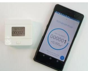
7. Выносной дисплей или смартфон с установленным приложением счетчики Элехант.
