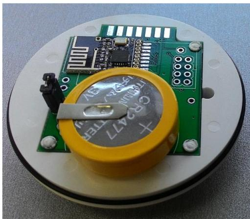
4. Одеваем резиновое уплотнительное кольцо на всю длину окружности подложки по малому наружному диаметру. Оно должно упираться в горизонтальную плоскость окружности большего диаметра.
