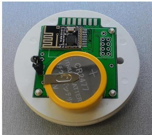
2. Аккуратным надавливанием на плату, углубляем её до упора в подложку так, чтобы все ножки вошли в монтажные отверстия платы.
