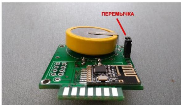
1. Снимаем перемычку с платы.
