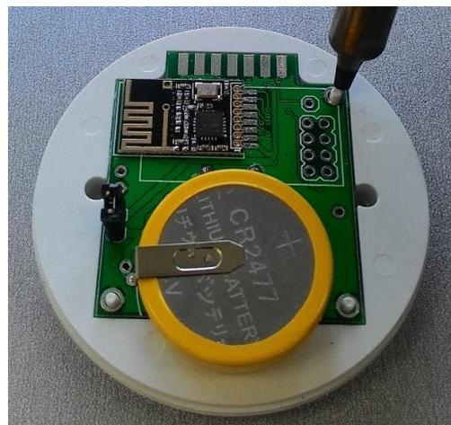
3. Разогретым паяльником, надавливая на каждую из трех ножек, формируем заклепочную поверхность над отверстиями платы, фиксирующие её в подложке.
