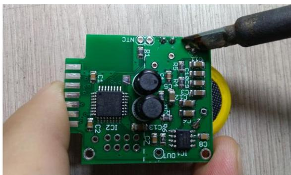
**Внимание!** Плата счетчика имеет относительно плотный монтаж радиоэлементов. Во избежание повреждения платы, соблюдайте осторожность при выпаивании элемента питания, не задевайте жалом паяльника близлежащие радиоэлементы.
