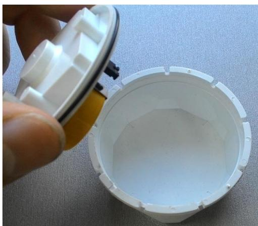
5. Располагаем пластиковый корпус внешней стороной вниз и вставляем подложку с платой в корпус так, чтобы плата находилась внутри корпуса.
