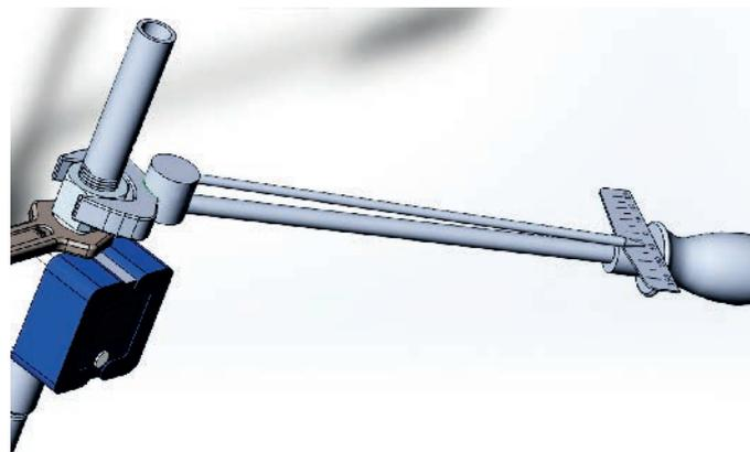
6. При монтаже счетчика на газопровод предварительно снять наклейки. Удерживать его ключом за четырехгранник со стороны гайки. Тем самым мы уменьшаем физическое воздействие, усилие на излом.
