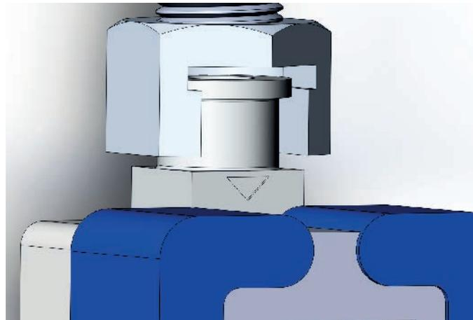
При правильности действий появляется достаточное пространство для установки паронитовой прокладки входящей в комплектацию счетчика. Если прокладка не входит значит допущены ошибки в предыдущих этапах монтажа.
