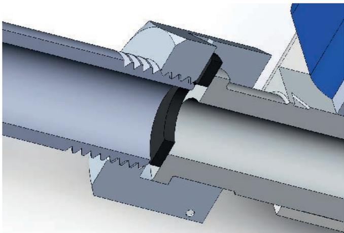
4.Торец присоединительной части газопроводной трубы(сгона) должен быть плоским и находиться под углом  $90^{\circ} \pm 1^{\circ}$  к оси ее резьбовой части.
