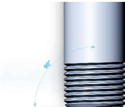
**Задиры, заусенцы, неровная, заостренная поверхность торца трубы не допускаются. Сгоны соответствующие данным замечаниям подлежат обязательной доработке или замене. Пренебрежения этими условиями ведут к повреждению (прорезанию, разрыву) паронитовой прокладки в следствии чего нарушаются ее уплотнительные свойства.**
