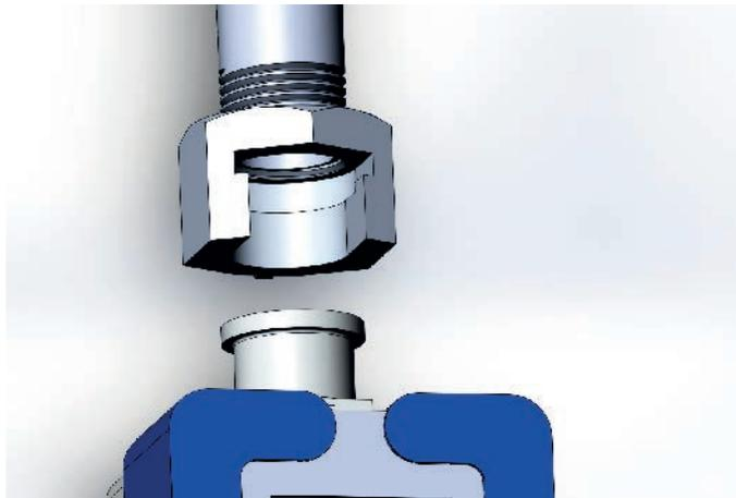
2. Присоединительный фланец корпуса счетчика вставить в паз гайки до упора, при этом он должен сесть в специальное центрирующее углубление.
